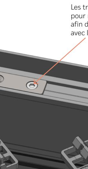
Les trous sont chanfreinés pour noyer les têtes de vis afin d'éviter les collisions avec le plateau.
