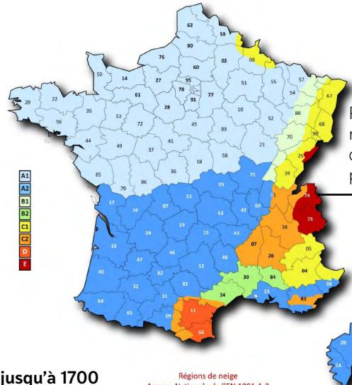
Charges de neige comprises dans les catégories **A à D jusqu'à 1700 m d'altitude** et pour la région **E jusqu'à 1000 m d'altitude**.
