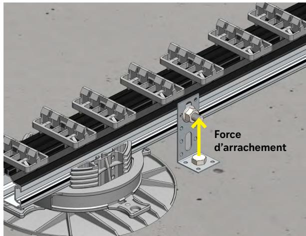
Utilisation d'une équerre ou feuillard avec boulons M8 pour ancrer la terrasse au sol. La fixation se fait en quinconce et le nombre d'ancrages par  $m^2$  peut être déterminé en prenant en compte la force de soulèvement due au vent et au poids propre de la terrasse.
