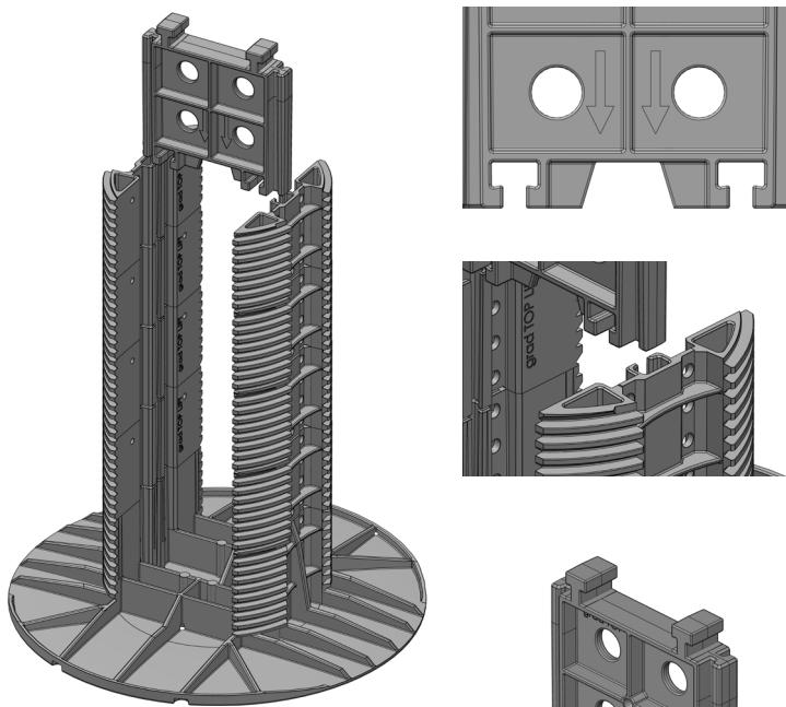
Les raidisseurs ont pour but de rigidifier la structure du plot. Ils peuvent être mis en œuvre lorsque la hauteur du plot atteint 200 mm.
