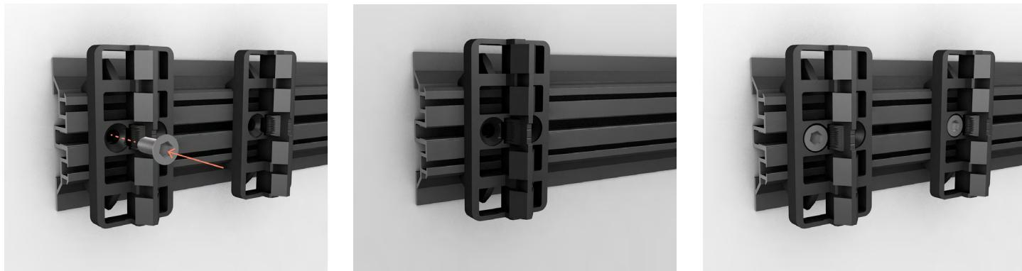
Une fois positionné, le clip peut être maintenu en place à l'aide d'une vis TF M5x12, qui se loge dans l'un des trous prévus à cet effet sur le clip, pour une fixation sur les rails avec rainure centrale taraudée (Flat Rail, PR).
