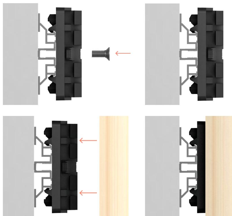
En cas de maintien en position avec une vis, le clip ne sera plus démontable avec le jeu de clés Grad.
