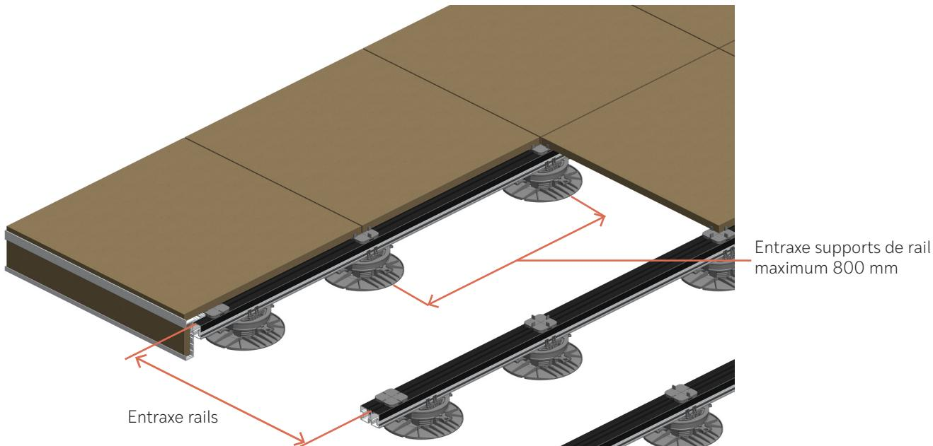
L'entraxe support des rails et l'entraxe rails est défini selon la dimensions des dalles. Il convient de placer un plot Top lift sous chaque support de dalle. La charge de la dalle est répartie sur les 4 supports de dalle.
