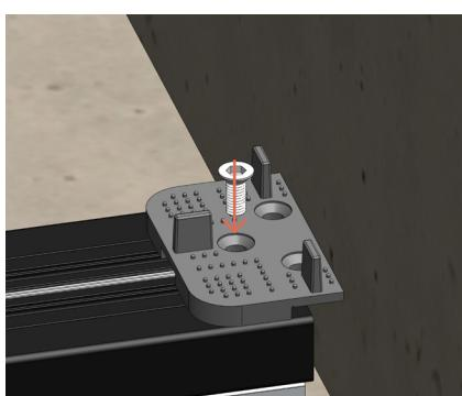
Dans ce cas de figure, il convient de visser le support de dalle avec une vis tête fraîsée M5x12 ref. 1241
