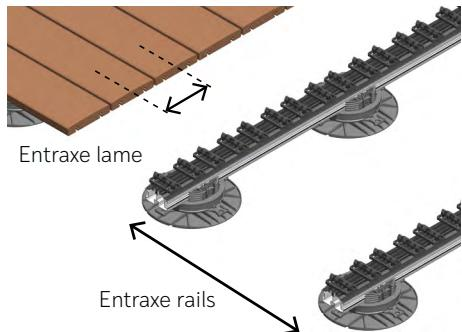
Les entraxes maximaux des rails respectent les contraintes de flèche et de charge des catégories d'usage.
