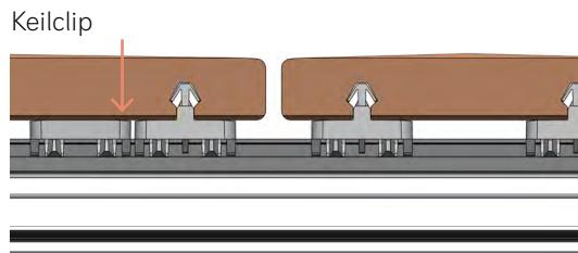
Für einen optimalen Halt der Diele ein 6-mm-Löch für eine Selbstbohrschraube SK 5 x 50 bohren.
