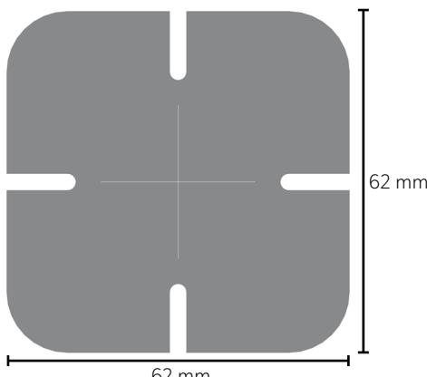
Komprimierbarer Dämpfungspolster zur punktuellen Unterfütterung.
