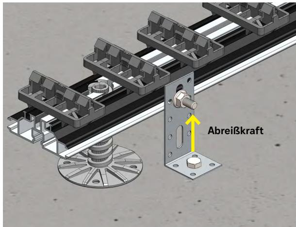
Verwenden Sie einen Winkel oder ein Metallband mit M6-Schrauben, um die Terrasse im Boden zu verankern. Die Verankerung wird versetzt angebracht und die Anzahl der Verankerungen pro  $m^2$  lässt sich unter Berücksichtigung der durch den Wind und das Eigengewicht der Terrasse verursachten Hebekraft bestimmen.
