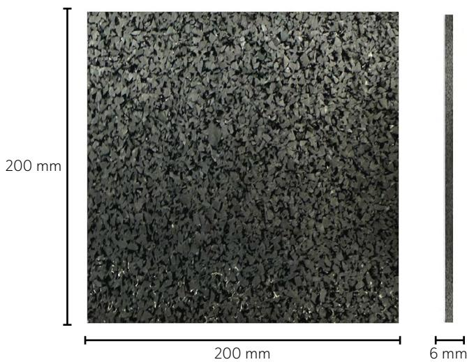
Bautenschutzmatten werden unter den Stellfüßen verlegt, um Kontakt mit Kunststoffmaterial von den Stellfüßen mit der Abdichtung zu vermeiden. Dadurch wird Weichmacherwanderung verhindert.
